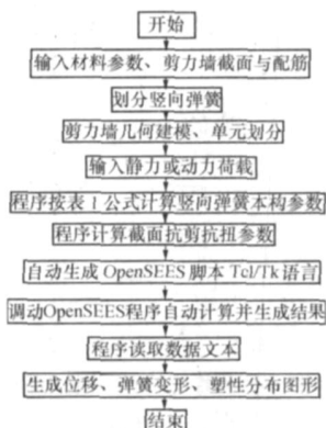
图 5 SWMA 程序流程图
